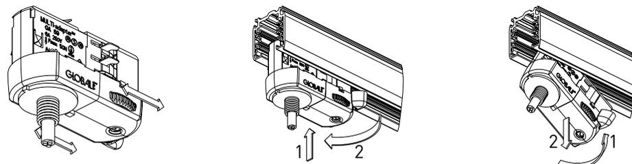
Vaiheet (1, 2 tai 3) voidaan valita ennen virran ottolaitteen kiinnitystä kiskoon tai kiinnitettyinä.
